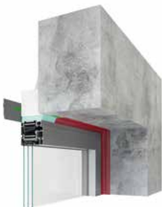
верхнє з'єднання, з застосуванням зовнішнього профілю одвірку
