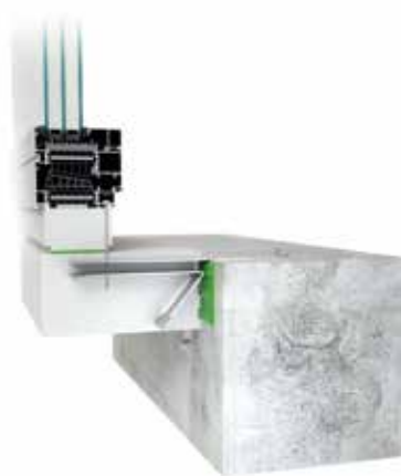
верхнє з'єднання із паронепроникною стрічкою та клеєм-ущільнювачем
