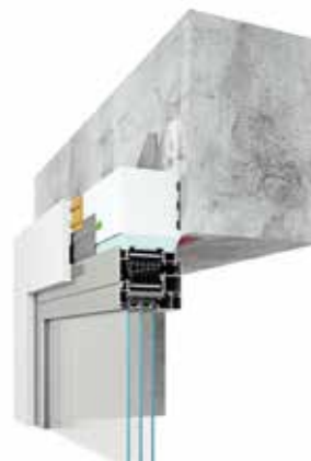
верхнє з'єднання з паронепроникною стрічкою та клеєм-ущільнювачем
